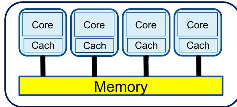
NUMA (Non-Uniform Memory Access) 共有メモリ型マルチプロセッサ計算システム
